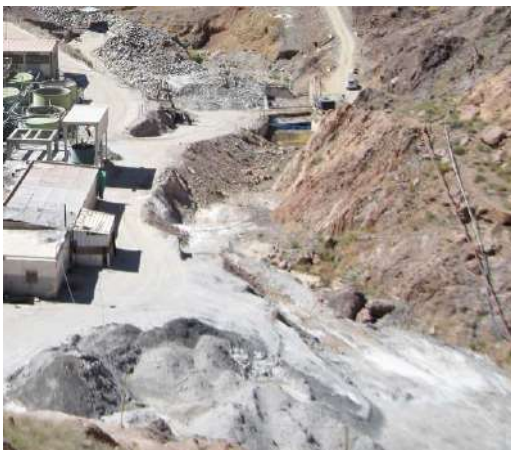
Un stock de matériaux cyanurés attend son évacuation avant les pluies !
